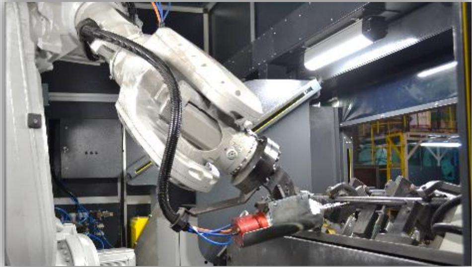
Ürune özel 3 farklı eksendeki hassas ve açılı deliklerin delinmesi amacı ile kurulmuş, 360° dönebilme kabiliyetine sahip pozisyonerleri ile geliştirilmiş olan robot hücremiz.
